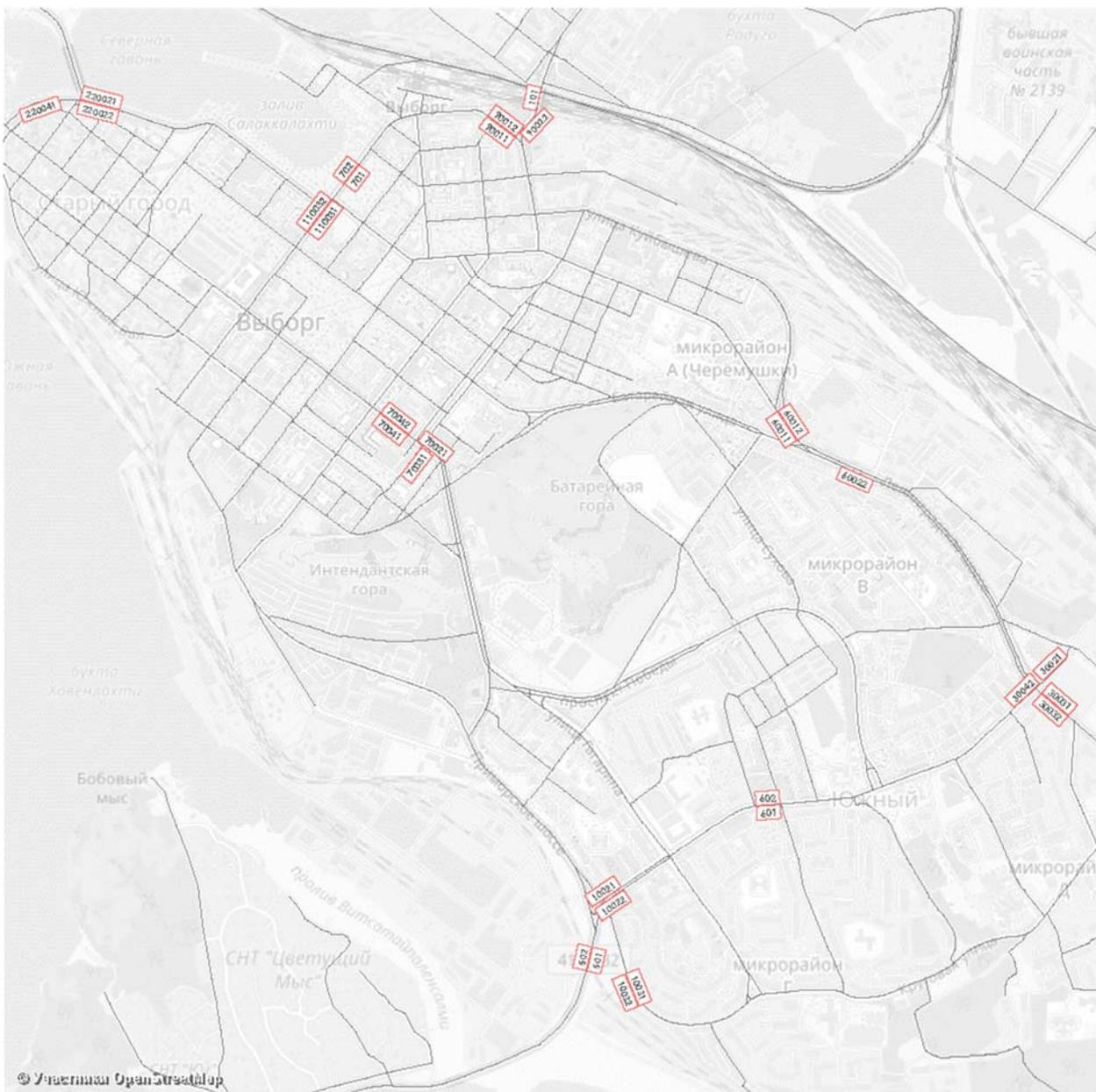
Рисунок 2.4.4 – Расположение сечений натурального обследования в зоне плотной застройки
